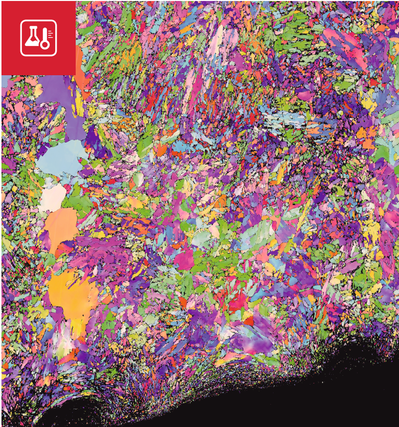
Mittels EBSD im Rasterelektronenmikroskop erzeugtes Bild einerschleifgehärteten Probe aus 42CrMo4 Stahl. | Lisa Ehle
