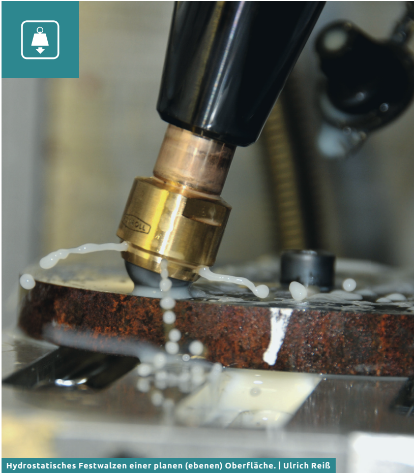
Hydrostatisches Festwalzen einer planen (ebenen) Oberfläche. | Ulrich Reiß
